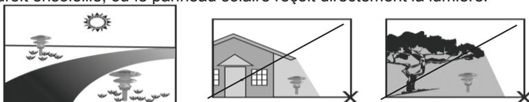
Assurez-vous que le panneau solaire soit orienté de telle façon qu'il ne recevra aucune lumière environnante à la tombée de la nuit (réverbères, projecteurs). Dans le cas contraire, le circuit de commande d'éclairage automatique ne pourra pas fonctionner et la borne solaire restera éteinte.
