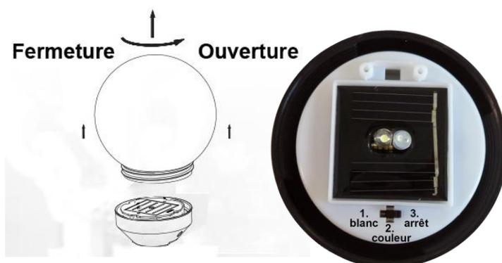
Puis refermer fermement le globe en tournant dans le sens des aiguilles d'une montre.
