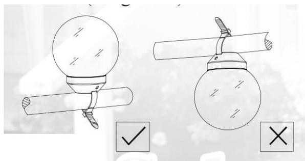
La boule doit être orientée vers le haut. Ne pas mettre vers le bas.
